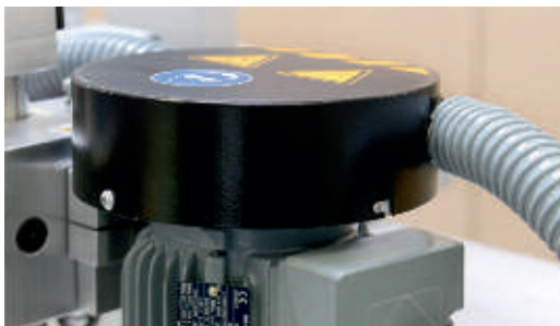
Doppelschleifrad mit grobem (P120) und feinem (P320 oder P400) Schleifband. Alternativ: diamantbeschichtetes Doppelschleifrad mit grober und feiner industrieller Diamantbeschichtung.
